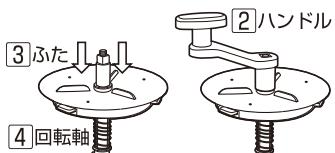
2. ネジが見えない状態なので、図のように④回転軸方向に押し、③ふたと②ハンドルを押し込みながら、①ハンドル固定ネジを取り付けます
