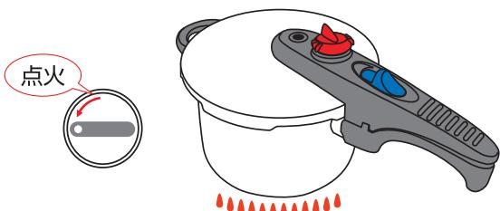
鍋に材料を入れてふたをセットし、強火にした後、圧力調整装置から蒸気が出始めたら、必ず弱火にしてください。この弱火にしてから、火を止めるまでの時間を加熱時間といいます。
