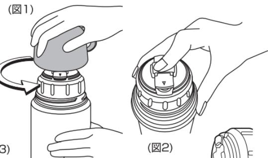
2.フタスイッチを押して、フタを開き(図2)、飲みものをカップに注ぎます。(図3)
