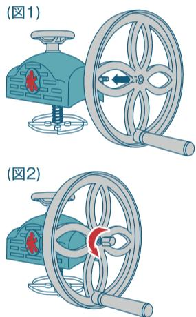
奥まで差し込まれていることを確認し、(図2)のように矢印方向にナットを回しハンドルを締め付けてください。
