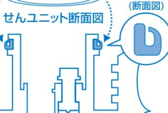
上下の方向を確認し、せんユニットに正しく取り付けてください。
